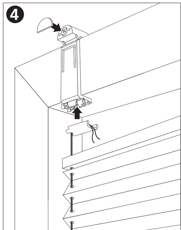
Mit den Falzfix-Trägern kann ein VS2-Plissee ohne zu bohren direkt vor der Scheibe befestigt werden. Dazu wird der Falzfixträger am Fensterflügel verklemt und die Halterung für das Plissee befindet sich in der Glasleiste. Weitere Befestigungstypen für Plissees finden Sie [hier](#).
