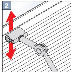
Das gespannte und frei verstellbare VS2-Plissee ist der beliebteste Plisseetyp für senkrechte Fenster. Dieser Plisseetyp wird mit Hilfe von Abdeckkappen an Spannschuhen montiert. Speziell für VS2-Plissees wurde die bohrfreie Befestigungsart mit Gelenkklebeplatten entwickelt. Bei dieser Befestigung werden die Spannschuhe aus einem Guss mit den Klebeplatten gefertigt und das [Plissee Rollo](#) kann schnell und unkompliziert am Fenster angebracht werden.
