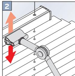
Diese trapezförmigen Plafond-Anlagen werden an den umlaufenden Montageprofilen einfach mittels Halteclips oder Wandwinkeln an den Rahmen der Wintergarten- oder Dachverglasung montiert. Die Bedienung erfolgt über formschöne Bediengriffe. Bei sehr hoch gelegenen Anlagen kann ein [Bedienstab](#) in einer Länge von bis zu 250 cm eingesetzt werden.
